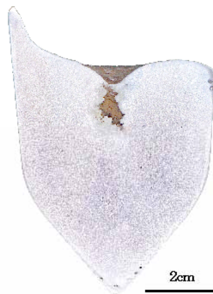
図 - 1 高純度合金断面のマクロ組織
