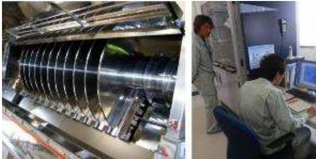
CDドライヤーに搭載された伝熱ディスクおよび応力測定の様子
