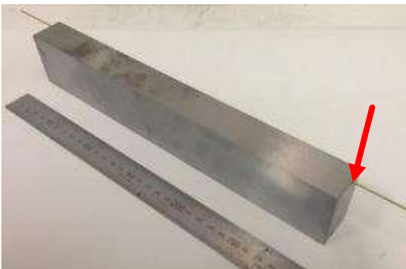
直径2mm、深さ300mmの穴加工(赤矢印)
