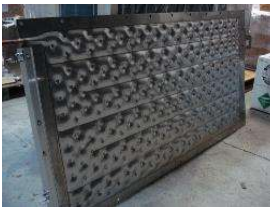
新構造低コストステンレス製氷板
