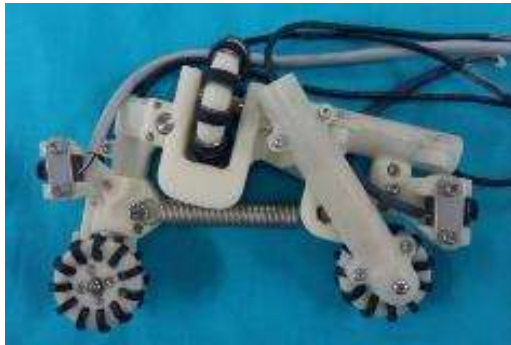
小径管内検査ロボット”マイクロエルポマスター”
