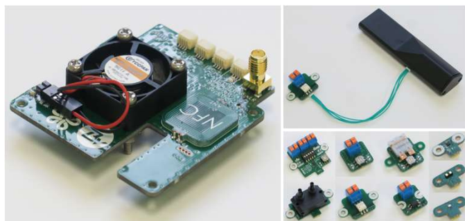
トランスミッターによるセンサーの無線化(右上) センサー基板(左)、様々なセンサー群(右下)
