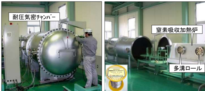
線材の連続固相窒素吸収処理装置 (左: 外観、右: 内部、製造品)
