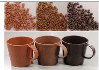
射出成型用木粉ペレットと射出成形したカップ
