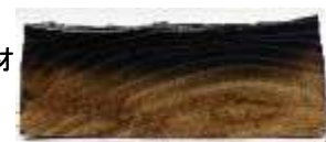
難燃処理木材 試験体
