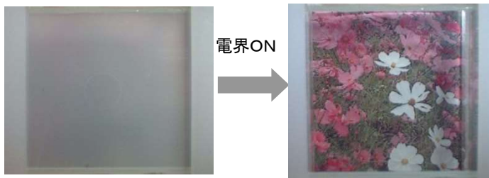
ノーマルモード型(高分子／液晶)複合膜を用いた調光シャッター
