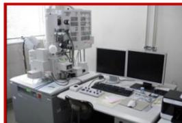
高分解能走査型電子顕微鏡
