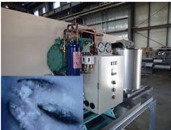
食品の急速凍結を目的とした低温蓄熱材用製氷機
