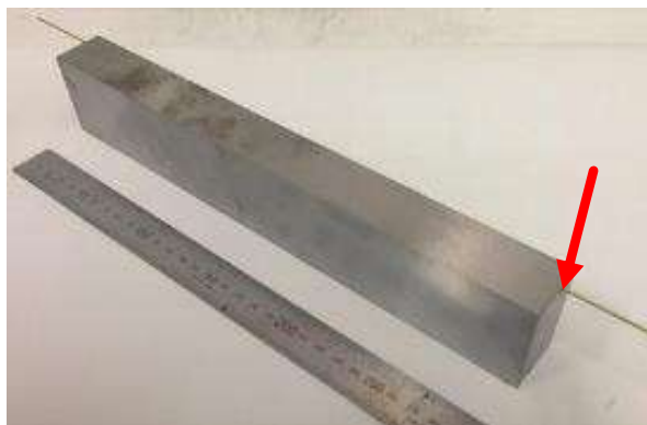
直径2mm、深さ300mmの穴加工(赤矢印)
