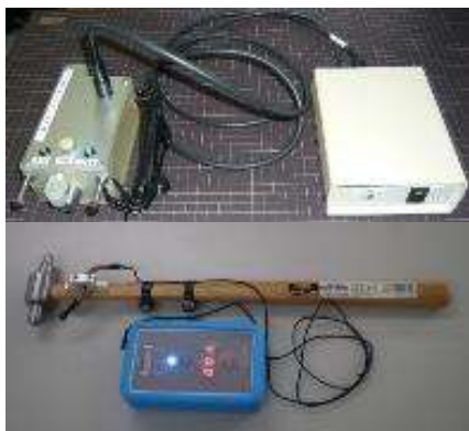
ソレノイド式打音検査装置(上)とハンマー式打音検査装置(下)
