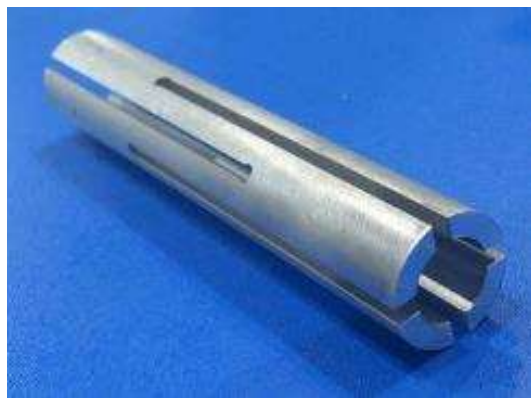
プラスチック金型用冷却促進構造
