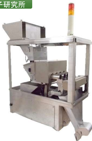
粉用自動計量で0.1gからの計量が可能な装置
