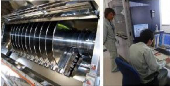
CDドライバーに搭載された伝熱ディスクおよび応力測定の様子
