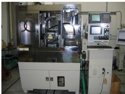
机上計測式研削盤
