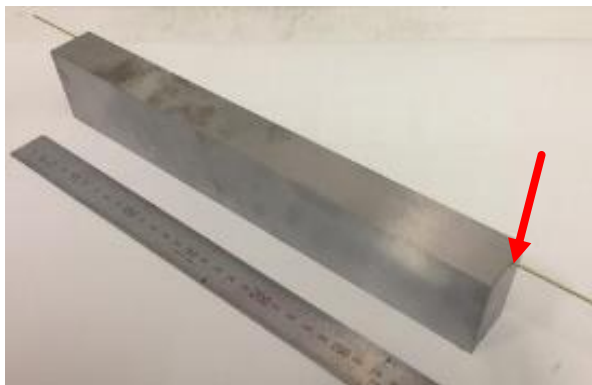
直径2mm、深さ300mmの穴加工（赤矢印）
