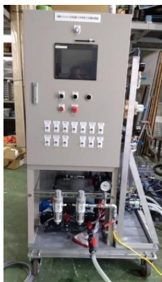
クロムめっき液再生装置
