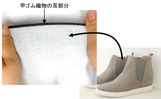
甲ゴム織物（ゴム入り織物）（左）と靴製品での使用例（右）
