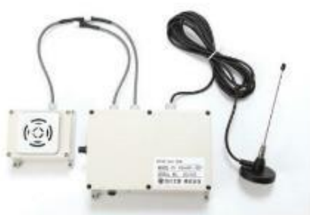
作業着接近検知システム
