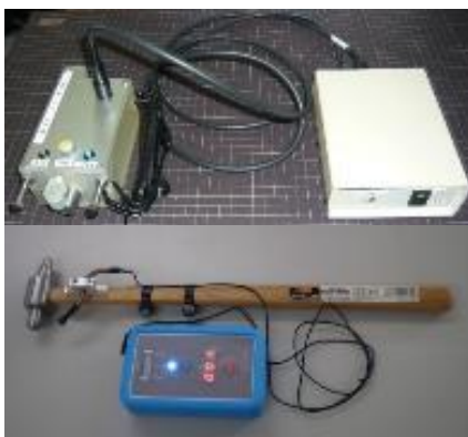
ソレノイド式打音検査装置(上)とハンマー式打音検査装置(下)
