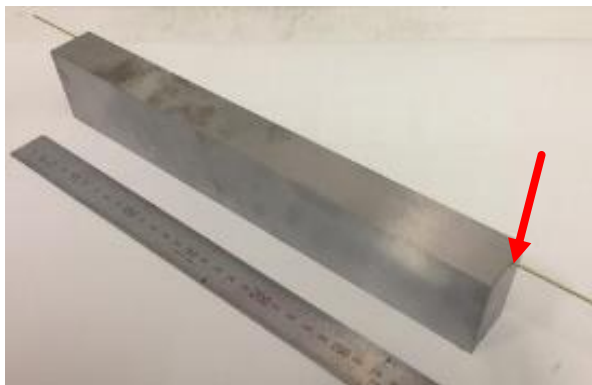
直径2mm、深さ300mmの穴加工（赤矢印）
