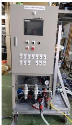
クロムめっき液再生装置
