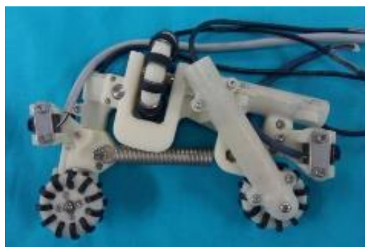
小径管内検査ロボット”マイクロエルボマスター”
