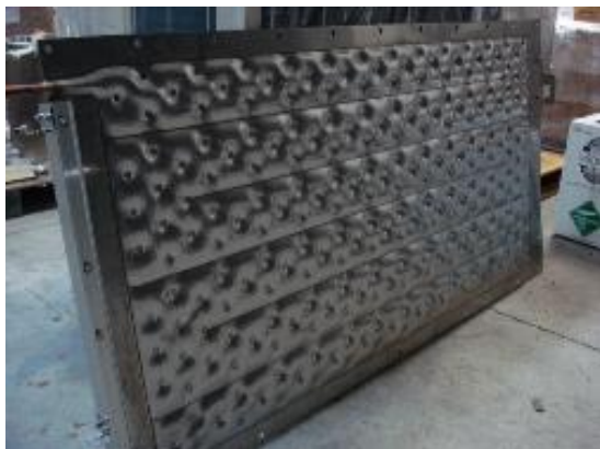
新構造低コストステンレス製氷板
