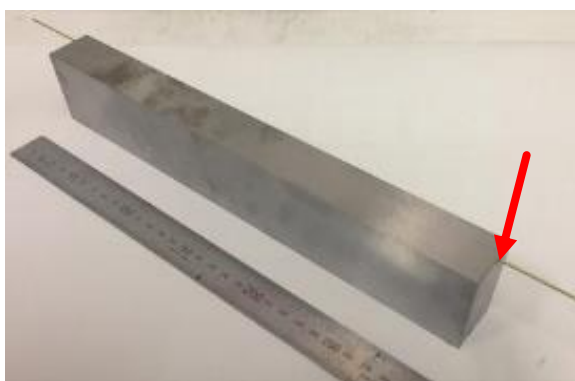
直径2mm、深さ300mmの穴加工(赤矢印)
