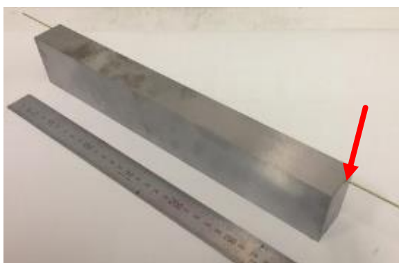
直径2mm、深さ300mmの穴加工(赤矢印)
