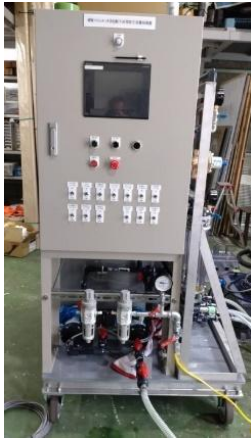
クロムめっき液再生装置
