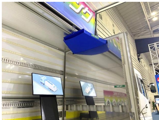
冷凍車温度均一化3Dダクト 取付写真(展示会出展)
