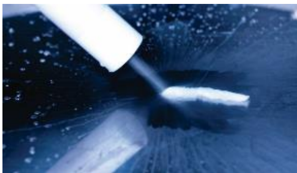
マイクロアイスジェットによる精密洗浄
