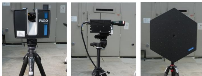
(1) 3Dスキャナー部 (3) 可視化用光源部 (4) 音源探査システム部
