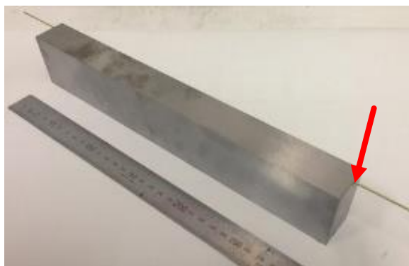
直径2mm、深さ300mmの穴加工（赤矢印）
