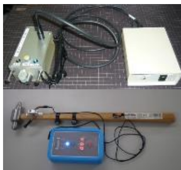
ソレノイド式打音検査装置(上) ハンマー式打音検査装置(下)
