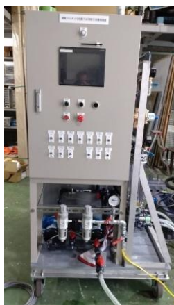
クロムめっき浴再生装置
