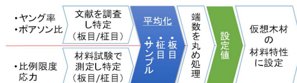
図2 仮想木材の材料特性設定工程
