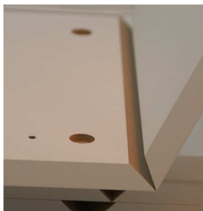
写真1 Vカット技術による部材の接合面
