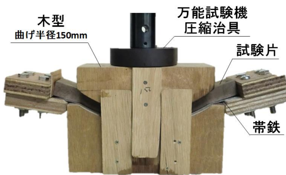
図1 曲げ半径150 mmの曲げ型および評価の様子
