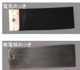
図2 電気, 無電解めっき被膜の外観 (PEI(分子量1200)1 g/L, CB(粒径50 nm) 1 g/L, めっき時間2h)
