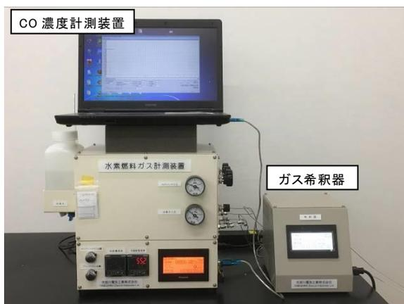
図1 評価対象装置（標準機）及び希釈器
