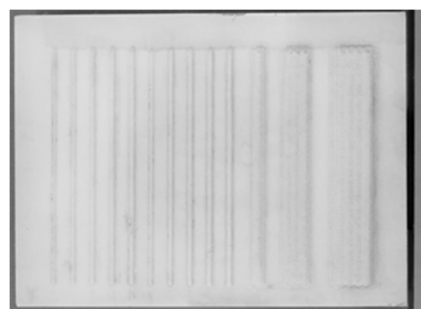
図 4 肉盛試験片の PT 検査結果（例）
