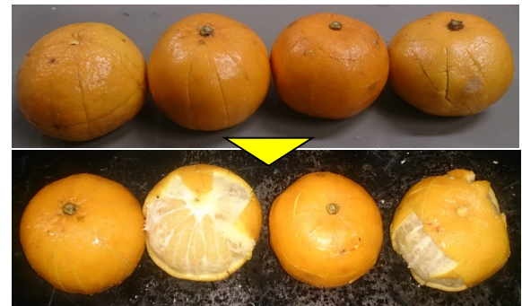
図7 スパイラルシャフト方式での剥皮状態
