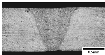
図4 突合せ溶接の断面組織
