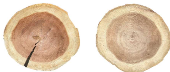
図1 V字割れした円盤材(左)と割れを抑えた円盤材(右)
