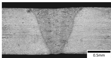
図4 突合せ溶接の断面組織
