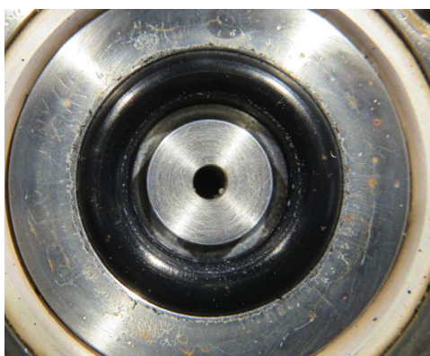
図4 低温高圧水素試験後のOリング
