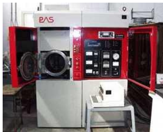
図 1 放電プラズマ焼結装置外観
