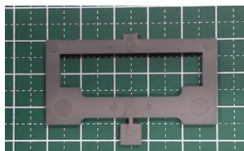
図7 グリーン体（試験片幅6mm，厚さ3mm，捨てボスのゲート幅1mm）
