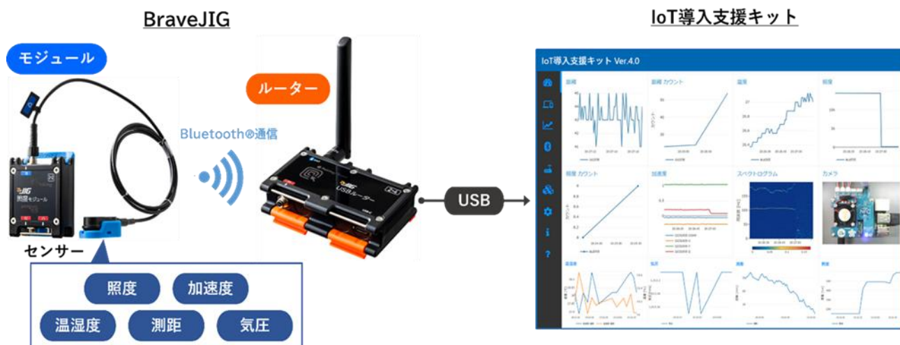
図1 BraveJIGとIoT導入支援キットの構成
