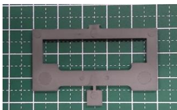
図7 グリーン体（試験片幅6mm、厚さ3mm、捨てボスのゲート幅1mm）
