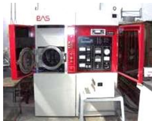
図 1 放電プラズマ焼結装置外観
