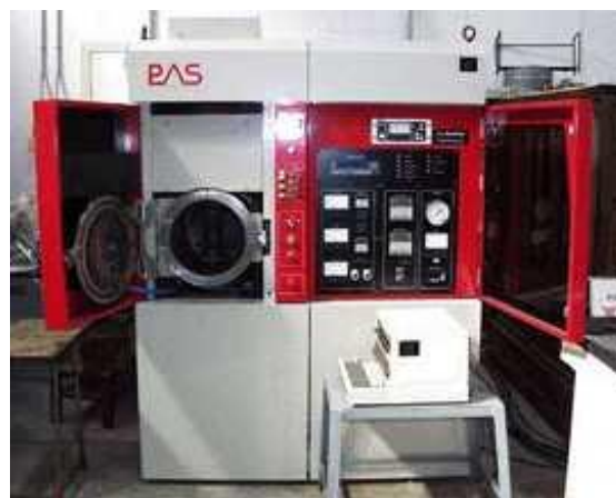
図 1 放電プラズマ焼結装置外観
