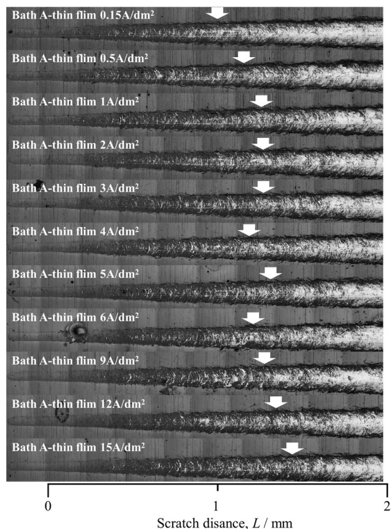
図4 めっき浴A（薄膜化条件）における F_n500 の位置
