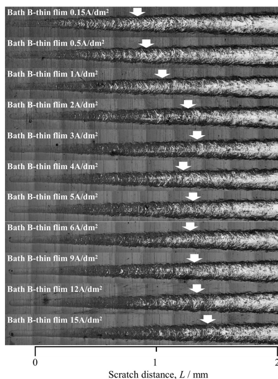
図6 めっき浴B（薄膜化条件）における F_n500 の位置
