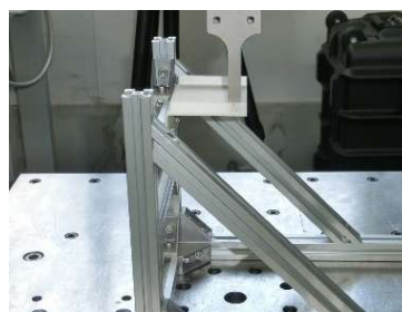
図 8 ブラケットの強度試験
