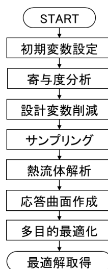
図2 応答曲面法を用いた最適設計フロー
