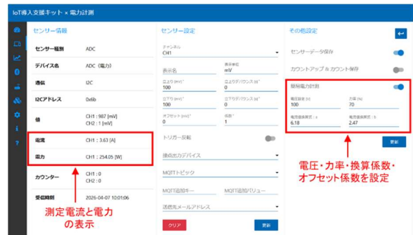
図5 電力測定に対応したIoT導入支援キット
