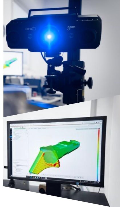
機械電子研究所導入 高精度3Dスキャナ 「ATOS 5」
