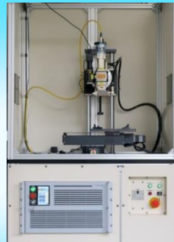
ファイバーレーザー溶接機 (R3.10月導入:1,020円/h)
