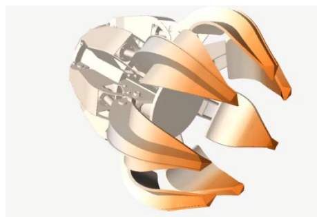
荷重を開く方向に加えたときの構造解析
