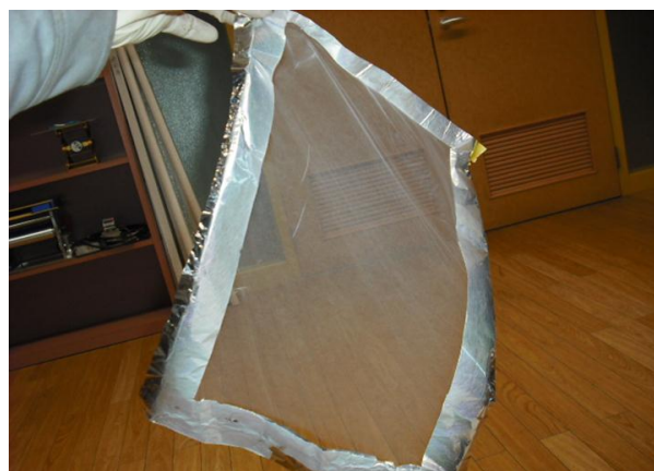
図2 作成した大面積極薄ナノファイバーシート (PEO, 繊維径480nm)
