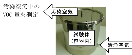
図1 小形チャンバー法による測定
