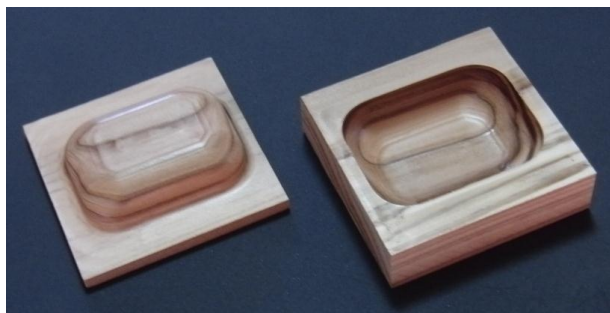
図7 曲面へ表層圧密加工した試作品
