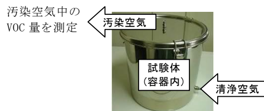
図2 小形チャンバー法による測定
