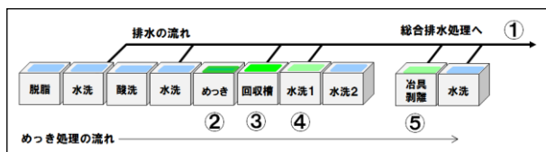
図1 一般的な錫めっきライン概略図
