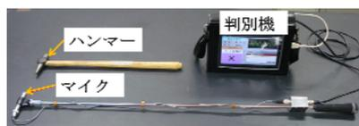
図4 打音検査試作機(新日本非破壊検査社製)
