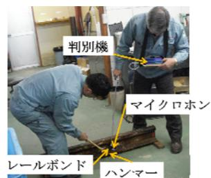
図5 打音検査試作機での実験風景
