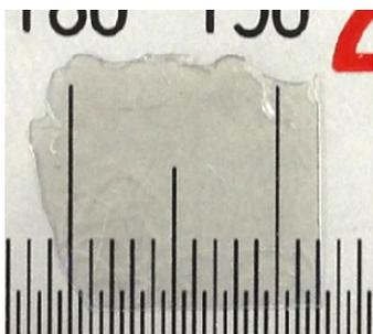
図 8 高濃度 BT10 含有量 BT10/PMMA ハイブリッドプレートの外観
