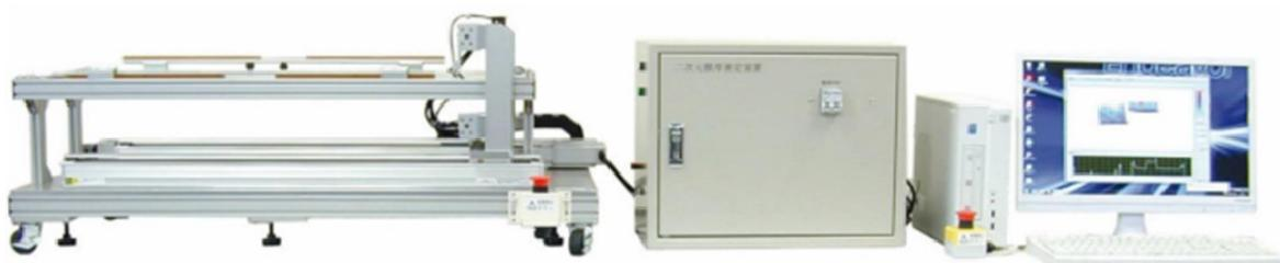
図 6 試作した走査型膜厚測定装置
