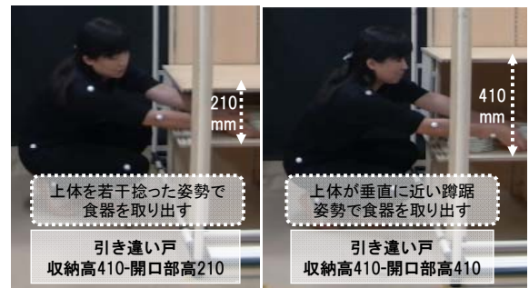
図8 動作空間750 mm-収納高410 mm条件での開口部高210 mmと410 mm条件の引き違い戸における収納動作
