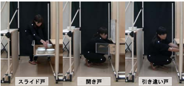
図6 動作空間750 mm-収納高410 mm条件での開口部高210 mm条件における各開閉様式の収納動作
