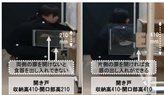
図7 動作空間750 mm-収納高410 mm条件での開口部高210 mmと410 mm条件の開き戸における収納動作
