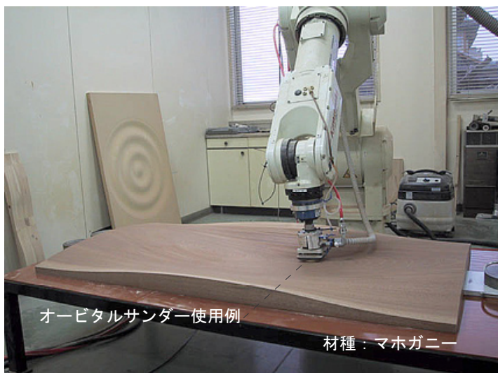
図-11 オービタルサンダーを用いた木地の研磨風景
