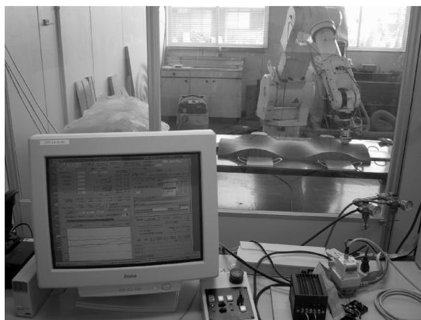
図 - 1 研磨ロボットシステム
