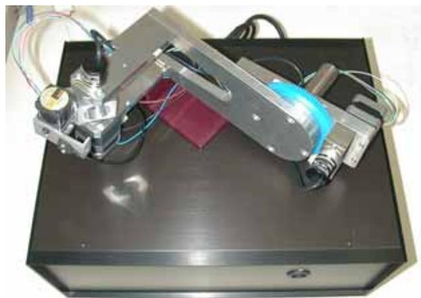
写真 - 1 溶接ヘッド及び制御装置
