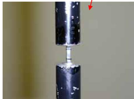
図-9 準静的引張試験
