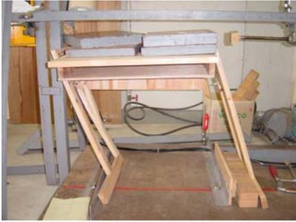
図-10 側方荷重試験による破壊例
