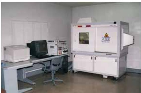
図-4 マイクロフォーカスX線CT装置
