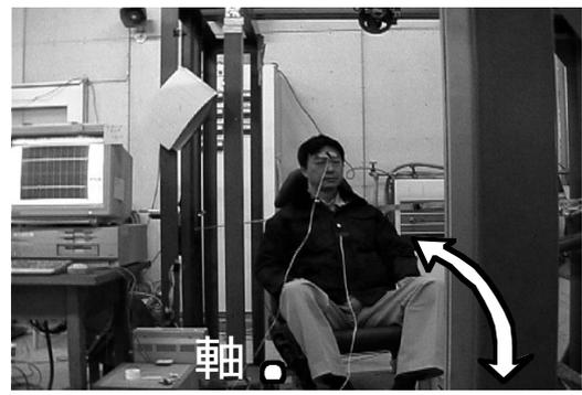
※シート右部下端を軸として、シート左部を3.75秒周期(0.27Hz)で高さ10cm程度上げる工程を繰り返し、シートの左右方向に振動を与えた
