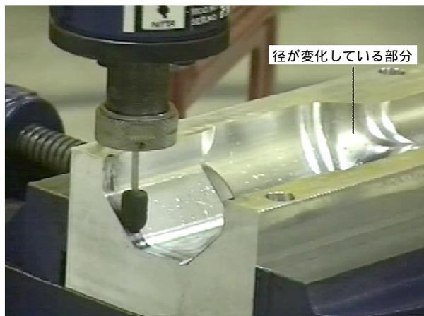
図-7 フェルトパフ工具での倣い実験
