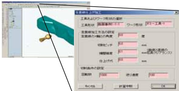
図3 <工程2> 試作コマンドの走査線仕上げ加工設定ダイアログで工具，ワーク形状を選択し，設定項目を入力する。
