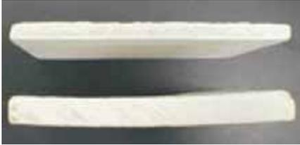
図-6 試作ケイ酸カルシウム系ボードの断面図
