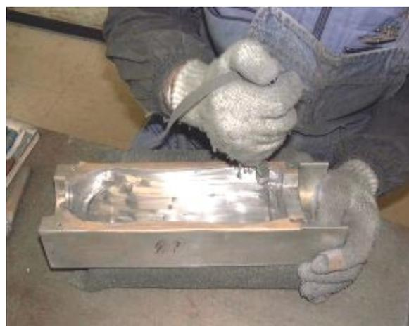
図-2 熟練者による金型の磨き風景
