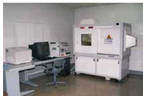
図 - 1 マイクロフォーカス X 線 CT 装置の外観
