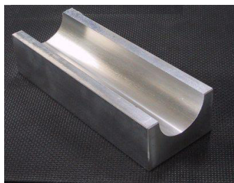
図 - 7 磨き実験で使用するワーク
