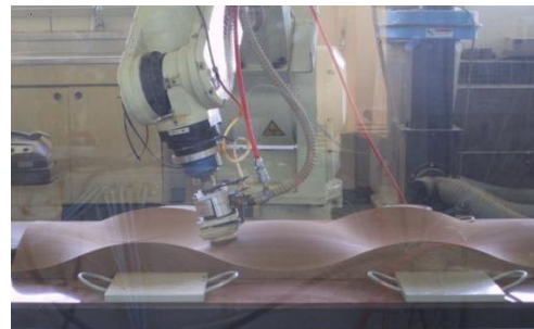
図-1 インテリジェントロボットサンダー
