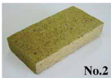
図-2 エコレンガ試作品外観 (灰含有量50vol%, 焼成温度: 1140 )
