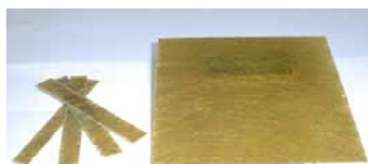
図-2 再生樹脂より成型したFRP
