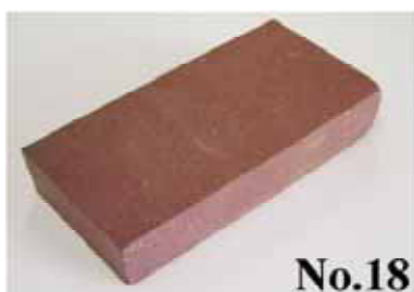
図-1 エコレンガ試作品外観 (灰含有量10vol%, 焼成温度: 1140 )
