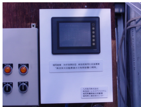
図-4 多入出力型熱流束式自動水分量測定制御機
