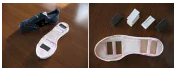
図2 実験に用いた重心を可変できる靴
