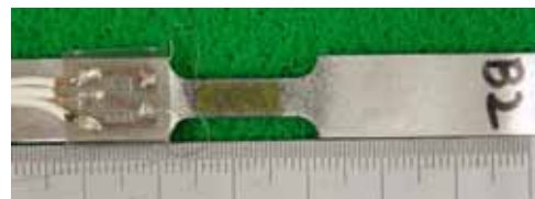
図4 ひずみゲージを貼った試験片
