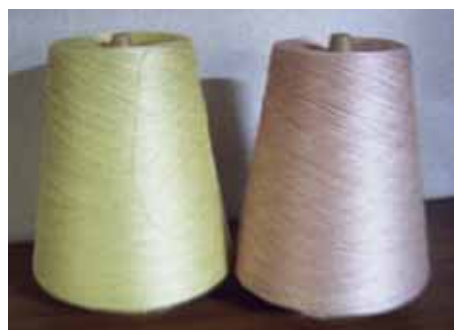
図6 スケールアップしたpH応答機能加工糸
