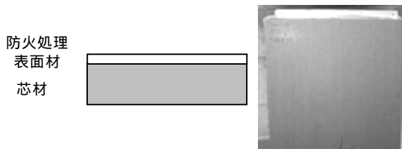
図4 試作部材の構成㊦と実物㊦
