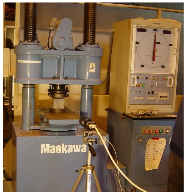
図2 2000kNの圧縮試験装置の写真
