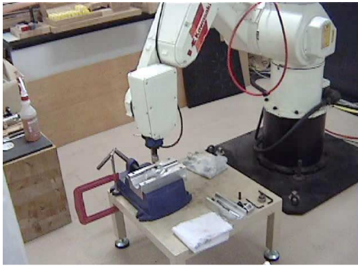
図7 産業用ロボットJS-10をベースとした実験システム
