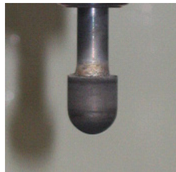
図1 半球形状に成形した有気孔メタルボンド砥石
