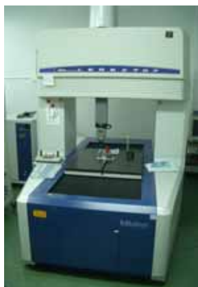
図1 三次元測定器 (Mitsutoyo LEGEX707)
