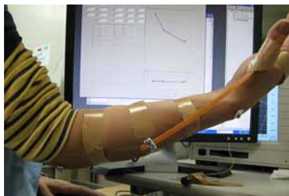
図4 手首の曲げ角、回旋角、肘の曲げ角の測定装置
