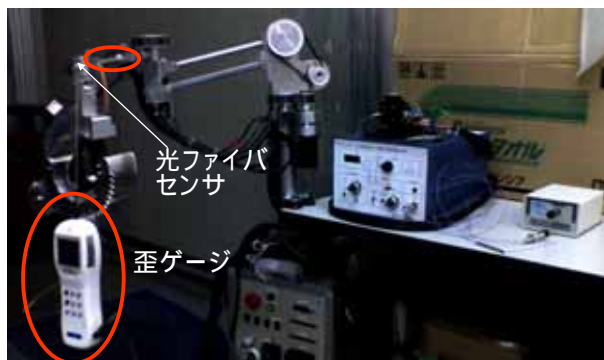
図4 上肢運動支援ロボットのアームの歪みを測定することによって要介護者の負荷を測定する装置写真
