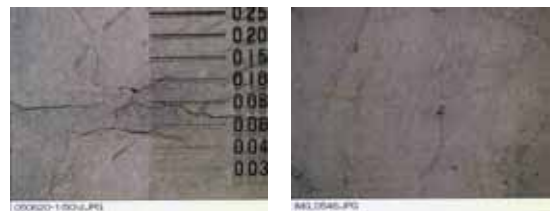
(A)発泡層無し (B)発泡層付き (左右写真の倍率は同じ)
