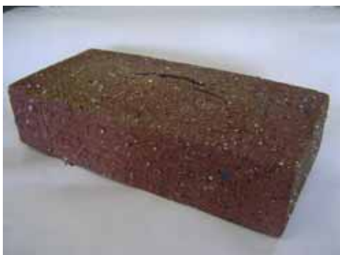
図2 脱塩焼却残渣含有レンガの外観 ( 廃含有率30vol% )
