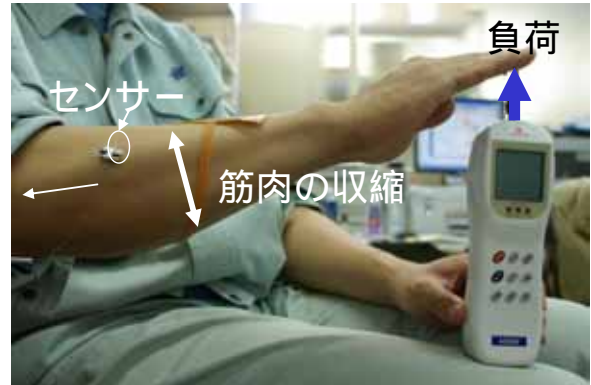
図6 要介護者の筋肉の伸縮を測定することによって要介護者の負荷を測定する装置写真
