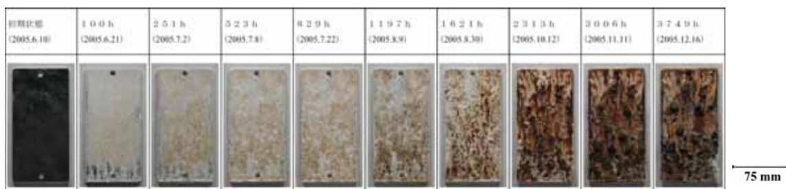
図4 溶融亜鉛めっき試験片の複合サイクル試験の結果（膜厚 80 μm，標準偏差 4 μm）
