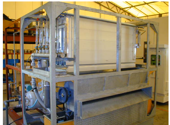
図2 アンモニア製氷機の外観
