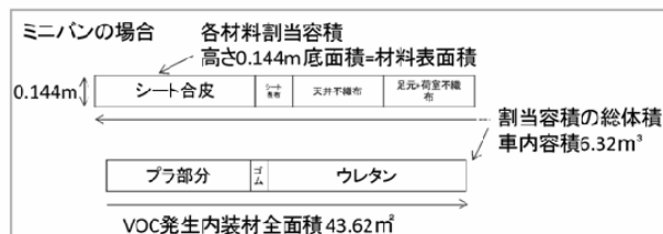
図4 軽ワゴン・ミニバンへの環境条件平均化モデル適用結果
