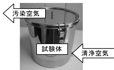
図2 小形チャンバー法による測定
