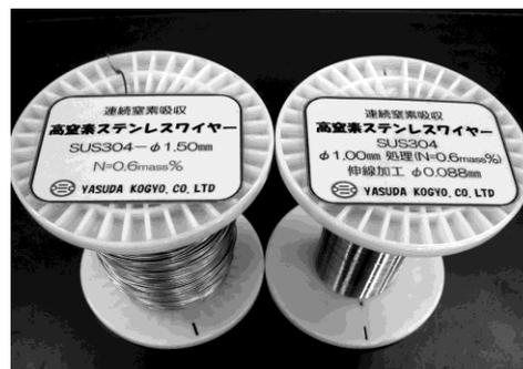
図7 高窒素SUS304線材の試作品
