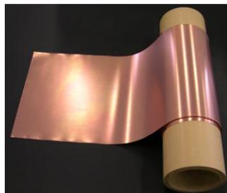
図1 roll to rollプロセスで銅箔上に連続形成したBaTiO<sub>3</sub>ナノ粒子堆積薄膜の外観写真
