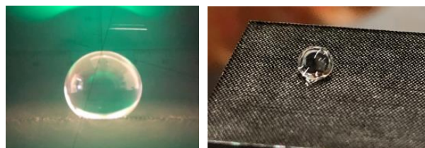
図8 接触角147°の撥水性表面
