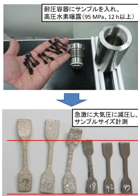
図2 高圧水素曝露試験の様子
