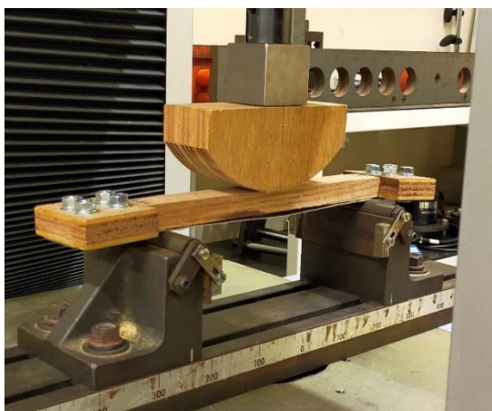
図1 曲げ半径100 mmの曲げ型および評価の様子
