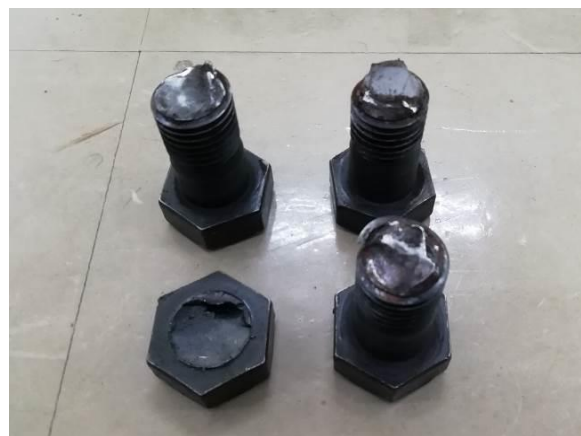
図11 破断したボルト
