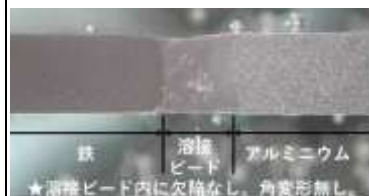
アルミニウム/鉄溶接部の断面
