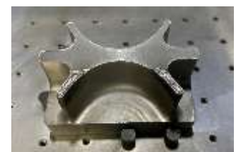
補修した金型部品
