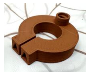
純銅製高周波焼入れコイルを模擬した造形サンプル
