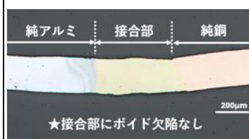
純アルミ/純銅の突合せ溶接部断面観察結果
